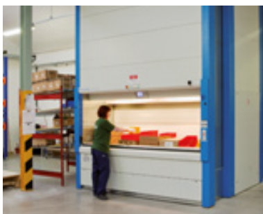
KARDEX. Velkokapacitní automatizovaný skladovací systém.
