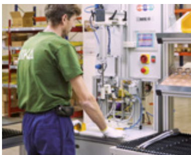
Vzduchový test na montážní lince.
