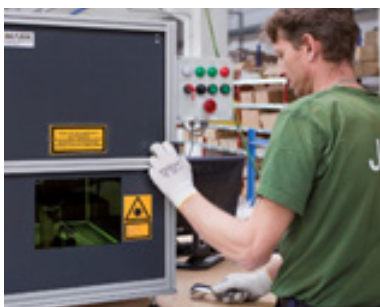
Laser při procesu vypalování loga.
